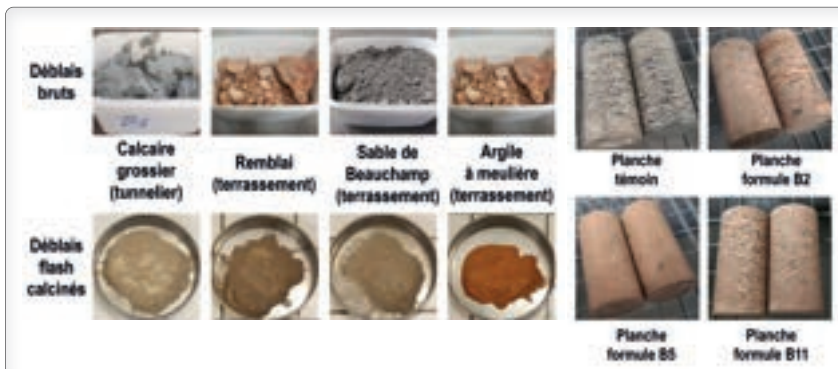
↑ Fig. 2 - Analyse et sélection des déblais destinés au procédé de flash-calcination et échantillons formulés.
