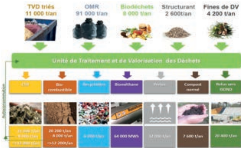
↑ Fig. 4 Schéma représentant le bilan matière de l'UTVD.
