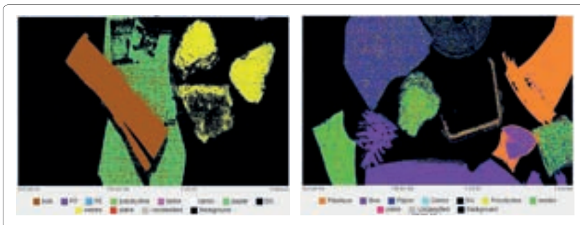
Fig. 3 Exemples de traitement d'image pour reconnaissance des matériaux. Source : Poly Process Solutions
